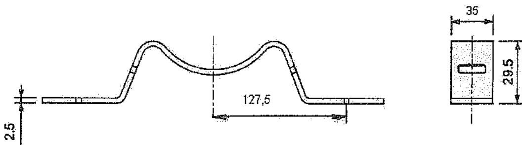
За монтаж се допускат различни от посоченото технически решения. Да са предназначени за стоманобетонни стълкове НН, стягане с неръждаема стоманена лента 20/0.4 mm и закрепяне с болтове M8 и разстояние между отворите по хоризонта 255 mm.
