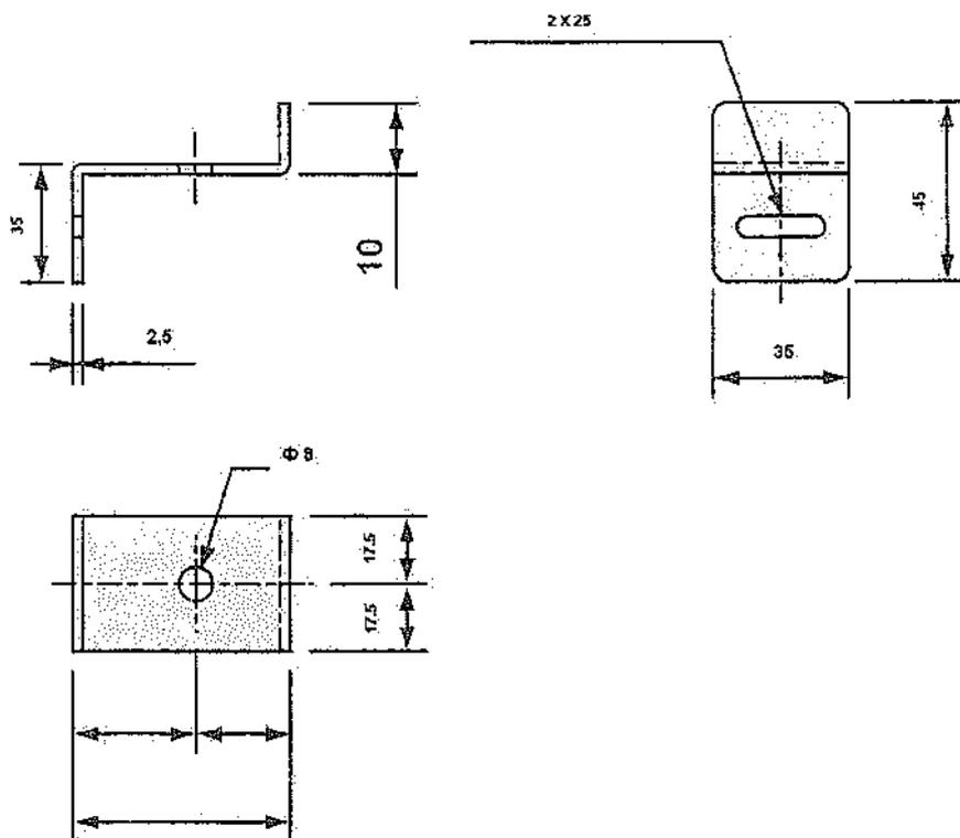
За монтаж на ТЕМО 1М се допускат различни от посоченото технически решения. Да са предназначени за стоманобетонни стълбове НН, стягане с неръждаема стоманена лента 20/0.4 mm и закрепяне с болтове М8.
