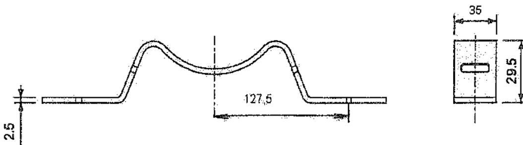
За монтаж се допускат различни от посоченото технически решения. Да са предназначени за стоманобетонни стълбове НН, стягане с неръждаема стоманена лента 20/0.4 mm и закрепяне с болтове М8 и разстояние между отворите по хоризонтала 255 mm.
